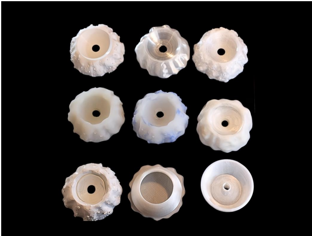
Figura 3. Muestras experimentales del prototipo en impresión 3D y silicona.
