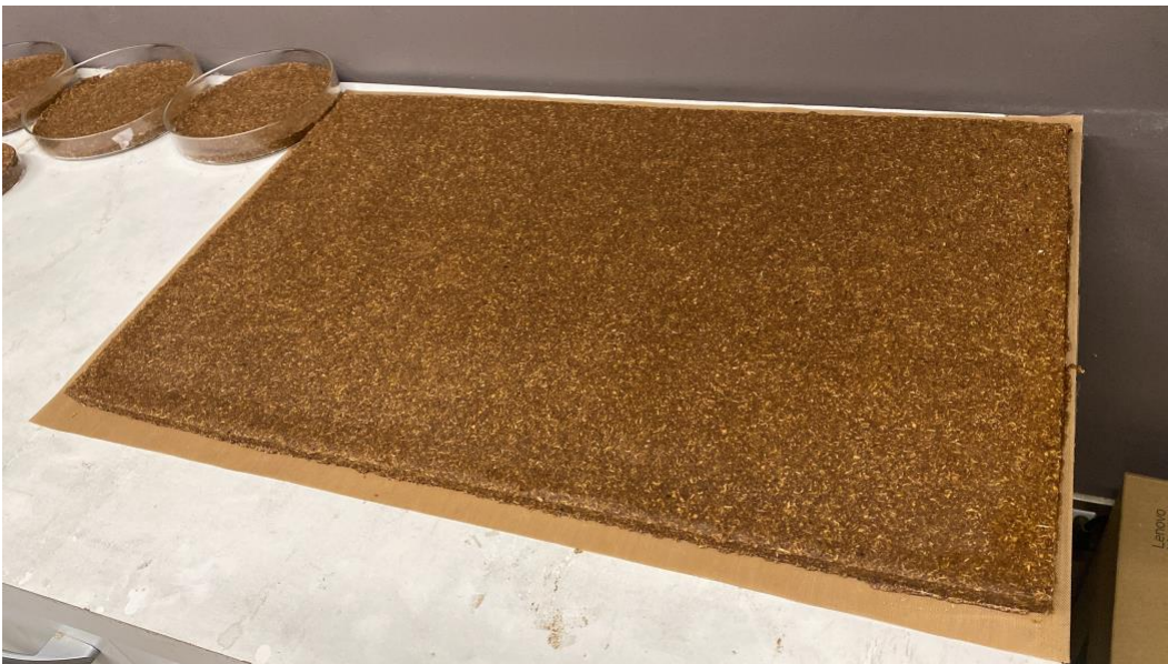
Figura 5. Panel compuesto de la mezcla de biopolímeros con aserrín vegetal. Se observa la integración homogénea de los componentes antes del moldeo y prensado.
