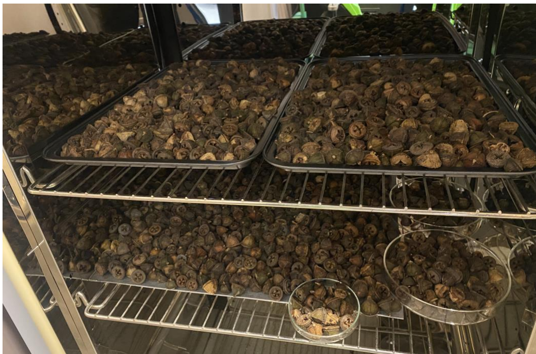
Figura 3. Proceso de secado. Se aprecia el secado de las cápsulas distribuidas de forma homogénea en el horno para eliminar la humedad interior.
