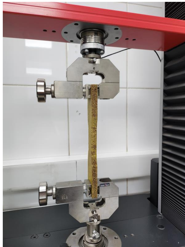
Figura 7. Ensayos de tracción. Las pruebas confirman la estabilidad dimensional y la resistencia del material frente a condiciones de tracción.
