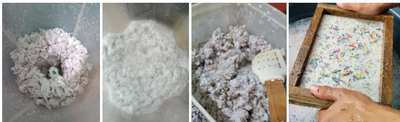
Figura 2. Proceso manual de reciclaje de papel.
