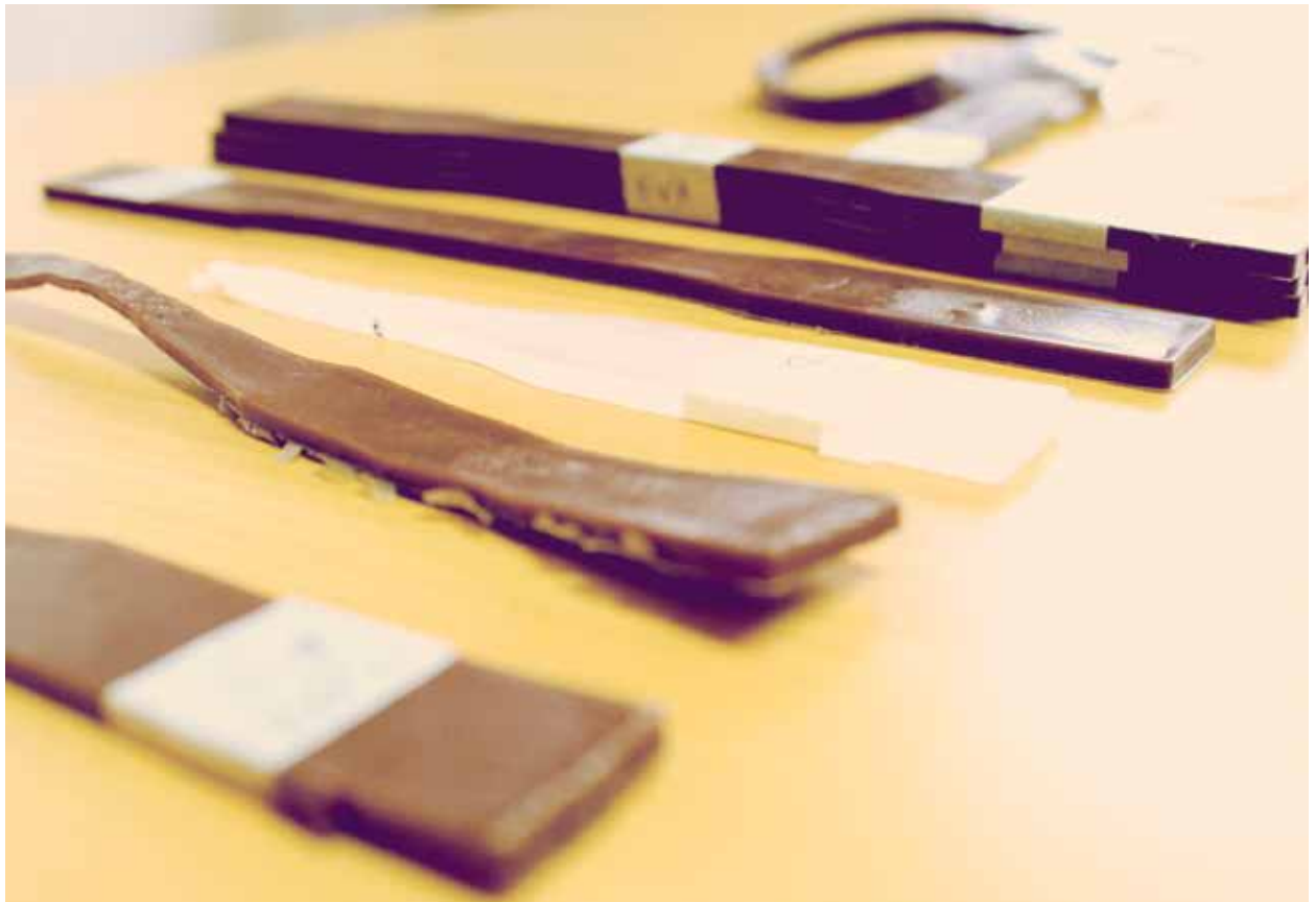
Probetas reforzadas con nanopartículas de cobre evaluadas mecánicamente
