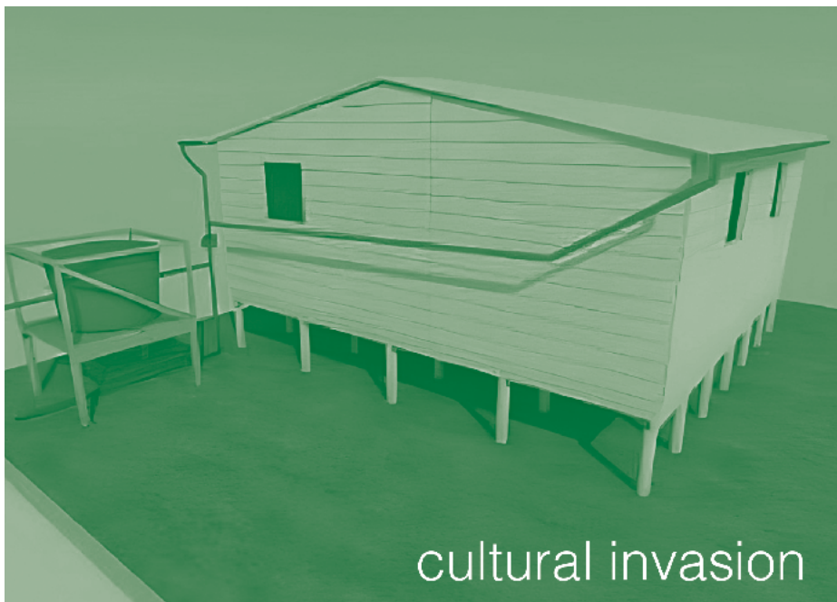
FIG 1. Sistema de captación de agua de lluvia utilizado por la ONG TETO en su vivienda de emergencia. Fuente: ONG TETO.
