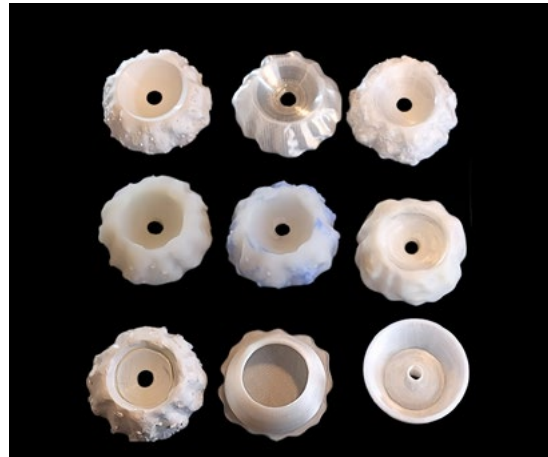
FIGURA 3. Muestras experimentales del prototipo en impresión 3D y silicona.
