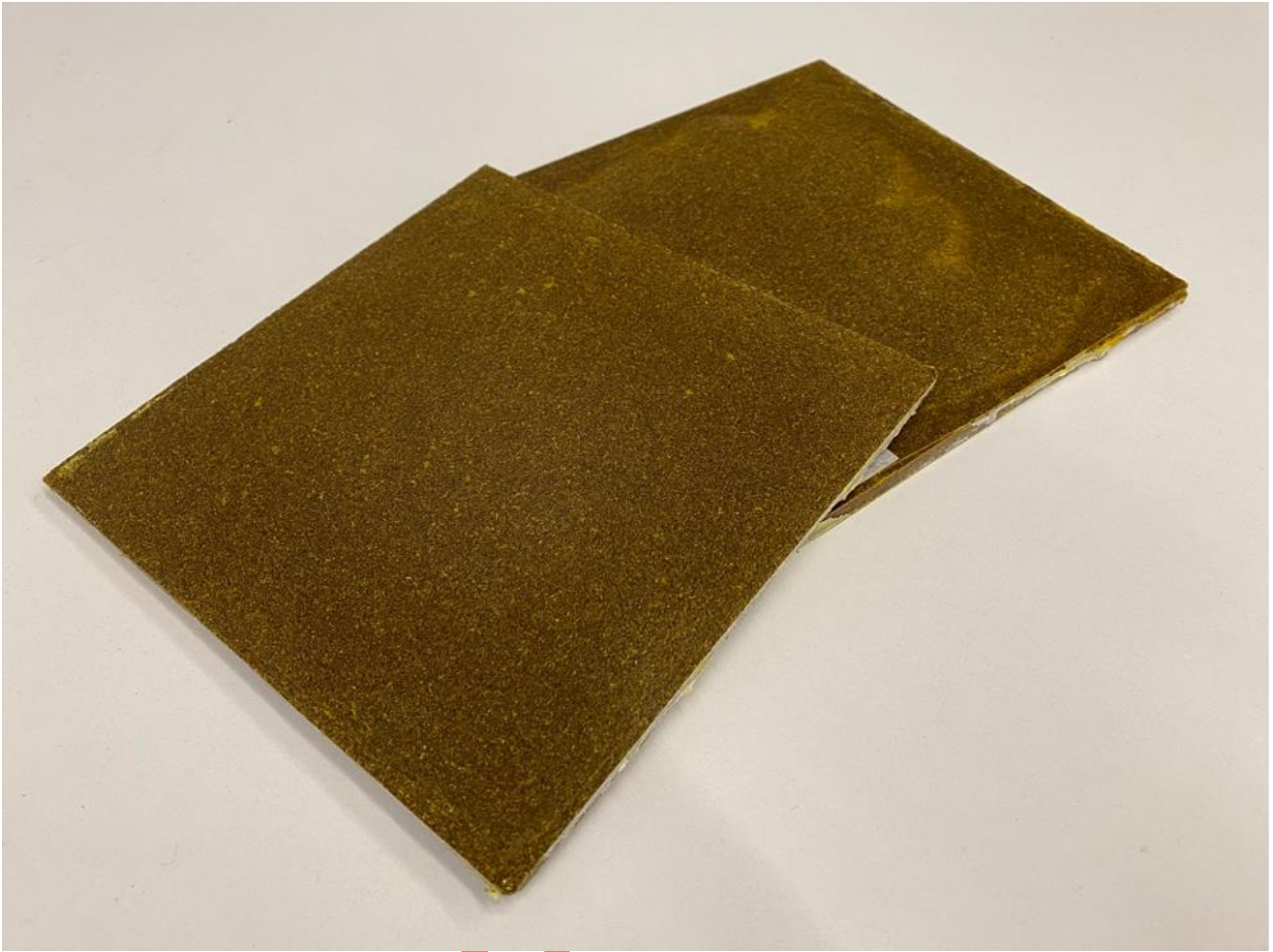
Figura 10. Panel bioaglomerado final tras curado térmico. Se aprecia la superficie uniforme, la compactación adecuada y la tonalidad natural del material sin aditivos químicos.
