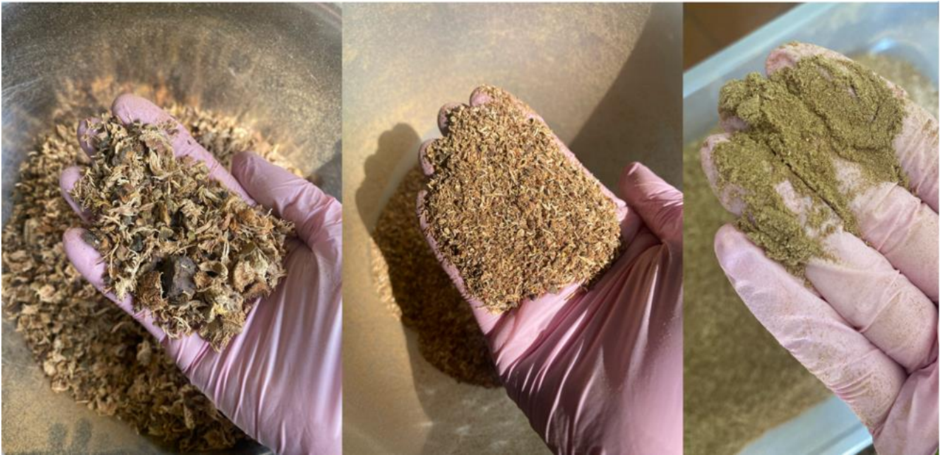
Figura 4. Proceso de molienda. Reducción uniforme de la granulometría de las cápsulas.
