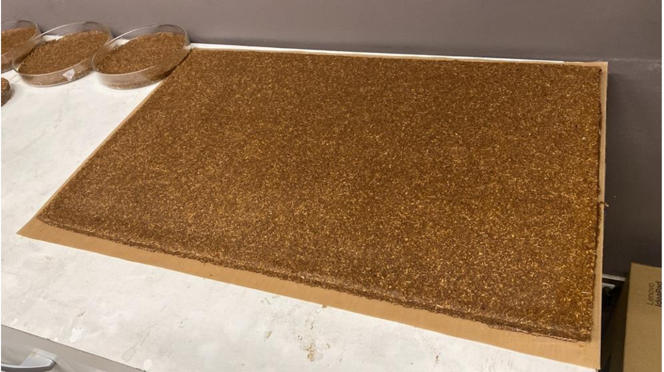
Figura 5. Panel compuesto de la mezcla de biopolímeros con aserrín vegetal. Se observa la integración homogénea de los componentes antes del moldeo y prensado.
