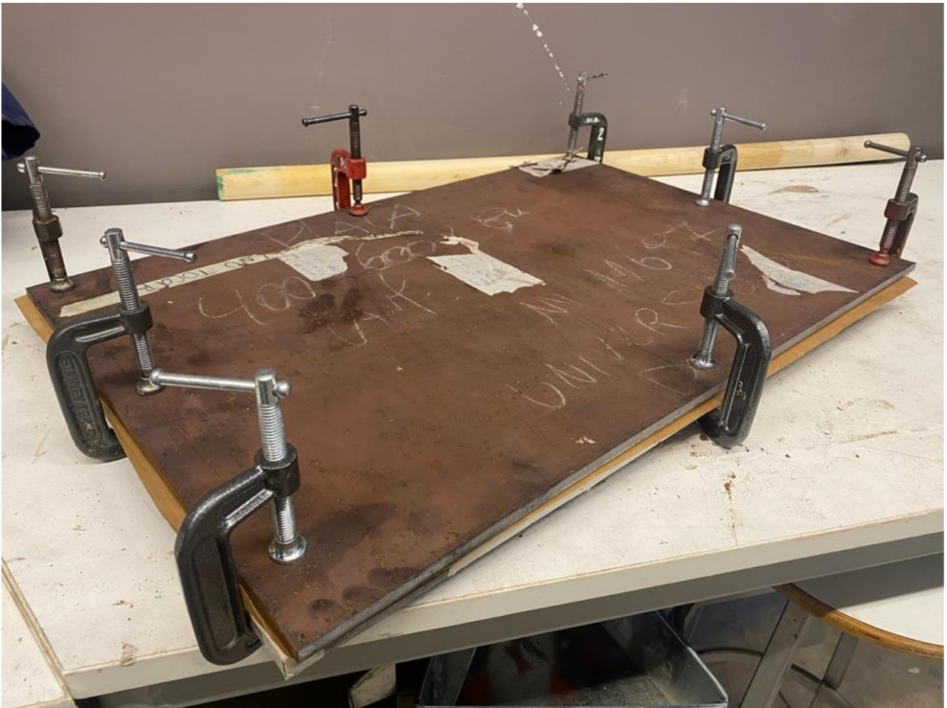
Figura 6. Paneles experimentales durante el proceso de prensado. Se evidencia la compactación homogénea de las extremidades del panel.
