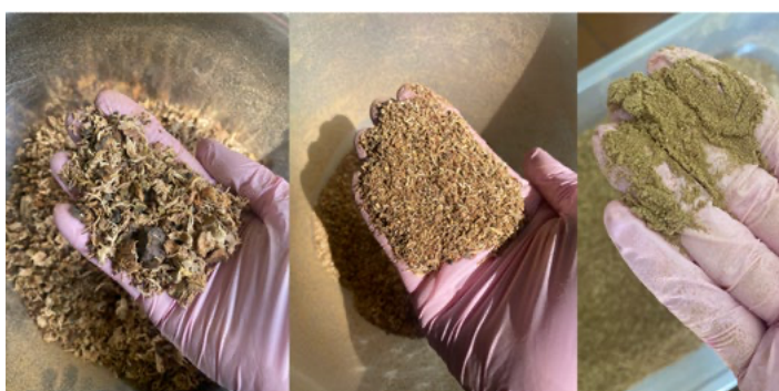
FIGURA 4. Proceso de molienda. Reducción uniforme de la granulometría de las cápsulas.
