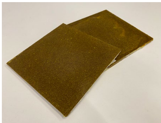
FIGURA 10. Panel bioaglomerado final tras curado térmico. Se aprecia la superficie uniforme, la compactación adecuada y la tonalidad natural del material sin aditivos químicos.
