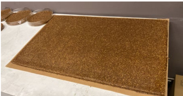
FIGURA 5. Panel compuesto de la mezcla de biopolímeros con aserrín vegetal. Se observa la integración homogénea de los componentes antes del moldeo y prensado.
