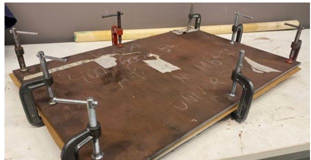
FIGURA 6. Paneles experimentales durante el proceso de prensado. Se evidencia la compactación homogénea de las extremidades del panel.
