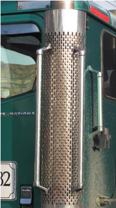
Figura 11. Silenciador metálico de camión. Fuente: fotografía de Alexandra Huertas (18 de noviembre).
