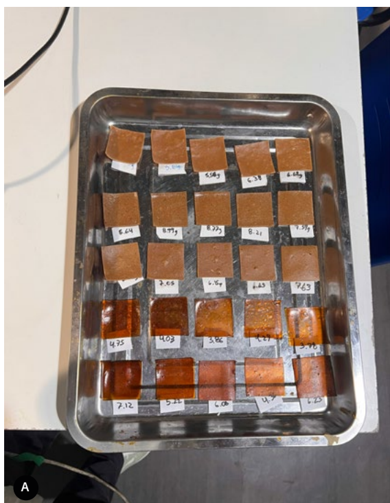
FIGURA 8A. Muestras masadas para ensayo de contenido de humedad (autoría propia), Figura 8B. Muestras posteriores a medición de contenido de humedad (elaboración propia).
