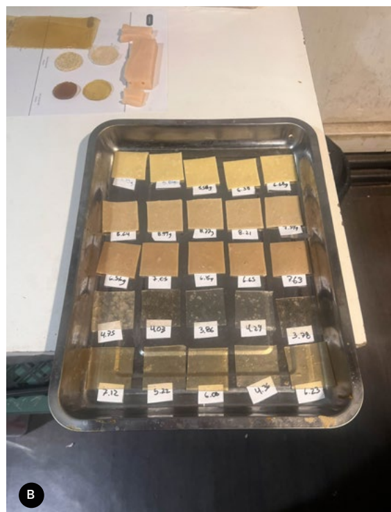
FIGURA 8A. Muestras masadas para ensayo de contenido de humedad (autoría propia), Figura 8B. Muestras posteriores a medición de contenido de humedad (elaboración propia).
