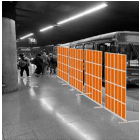
Figura 2. Panel modular prototipo instalado en tramo de prueba de la Estación Intermodal La Cisterna. Fuente: Lara Yáñez, 2024.
