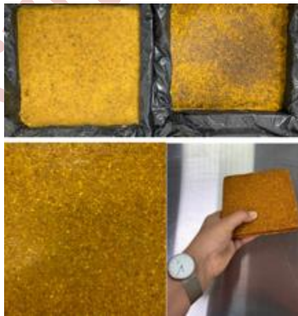
Figura 1. Probetas fabricadas para ensayos de conductividad térmica y acústica. Fuente: Lara Yáñez, 2024.
